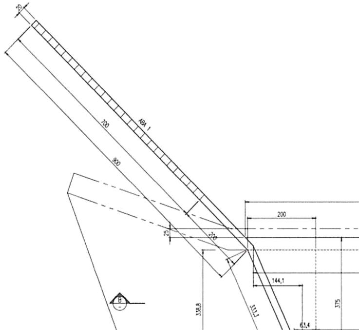
A linha contínua seria o projeto a ser construído e linha tracejado construção existente antes da elaboração do projeto.
